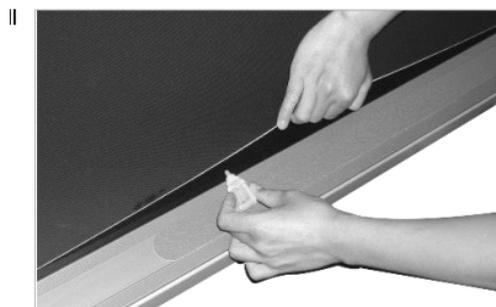
В зависимости от частоты и продолжительности тренировок, зависит частота смазки тренажера (см. таблицу).
