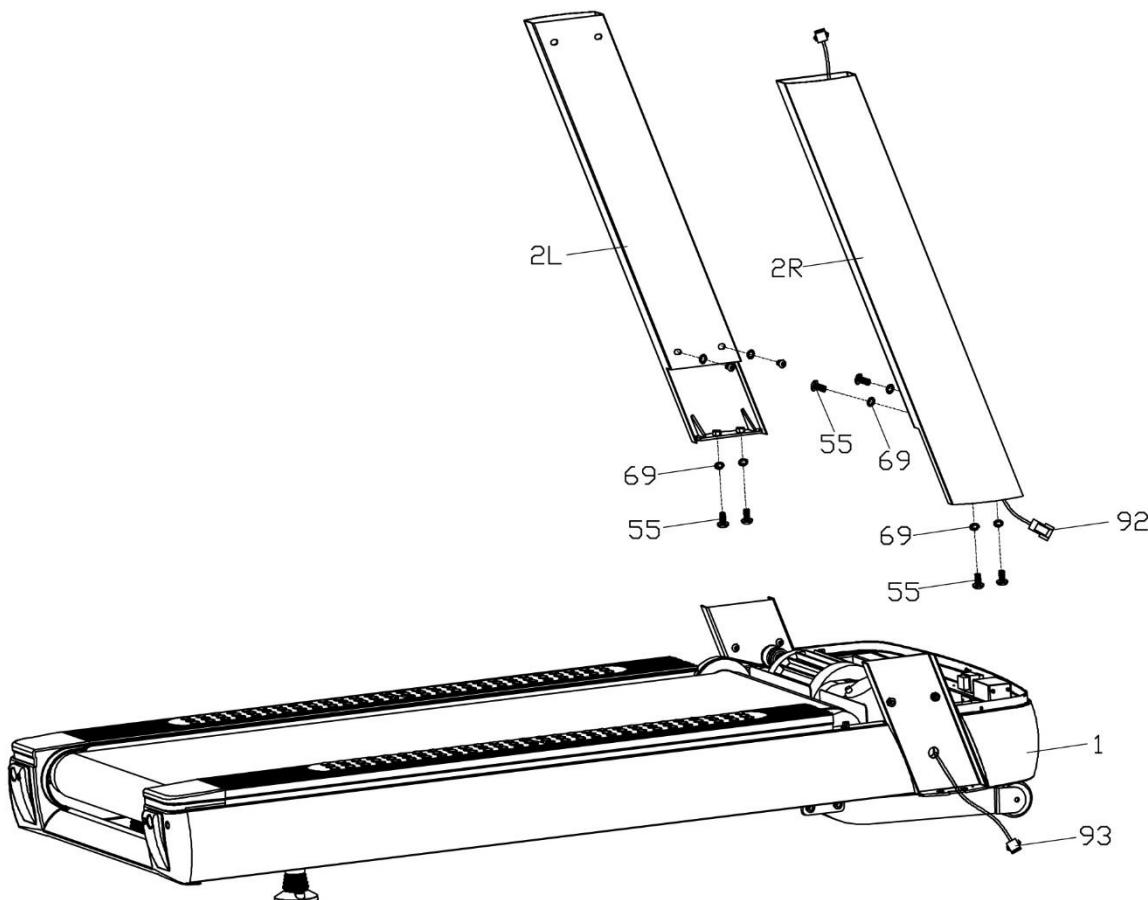
**ВНИМАНИЕ!** Будьте осторожны во время соединения кабелей консоли. На последних установлены фиксаторы, которые должны быть правильно соединены для нормального функционирования тренажера.
