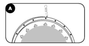
В. Поверните пружину в направлении батута (Рисунок В)
